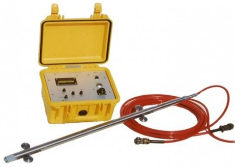
Thiết bị thí nghiệm xuyên tĩnh CPT/CPTu của
