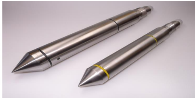
Thiết bị thí nghiệm xuyên tĩnh CPT/CPTu của
