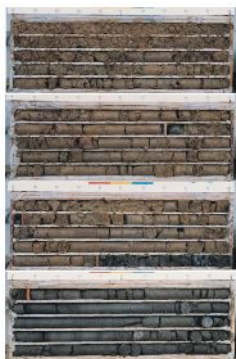
Hình 2-6: Minh họa kết quả khoan sát cấu trúc địa chất và đánh giá sâu mét rỗng
