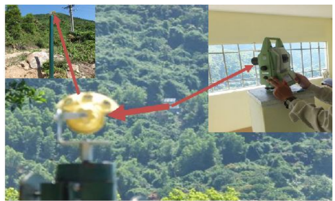
Hình 5-6: Máy toàn đạc điện tử đo góc và các điểm ngắm
